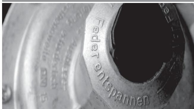
Регуляторы-стабилизаторы служат для выравнивания входного/выходного давления.
